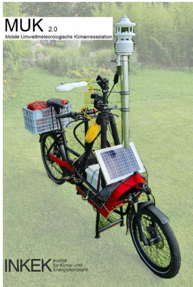
Abbildung 2.4: Ansicht der Messanordnung auf dem Elektro-Lastenrad. Das weiße Gehäuse ganz oben ist der Strahlenschutz, der den Temperaturfühler umgibt.
