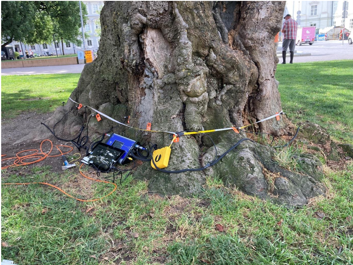
Aufbau der Schalltomographie am Stammfuß.
